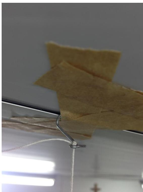
**Figura 4** – Suporte de suspensão com clipe metálico
